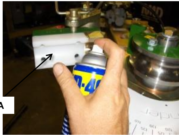
Lubricating counter die bending
